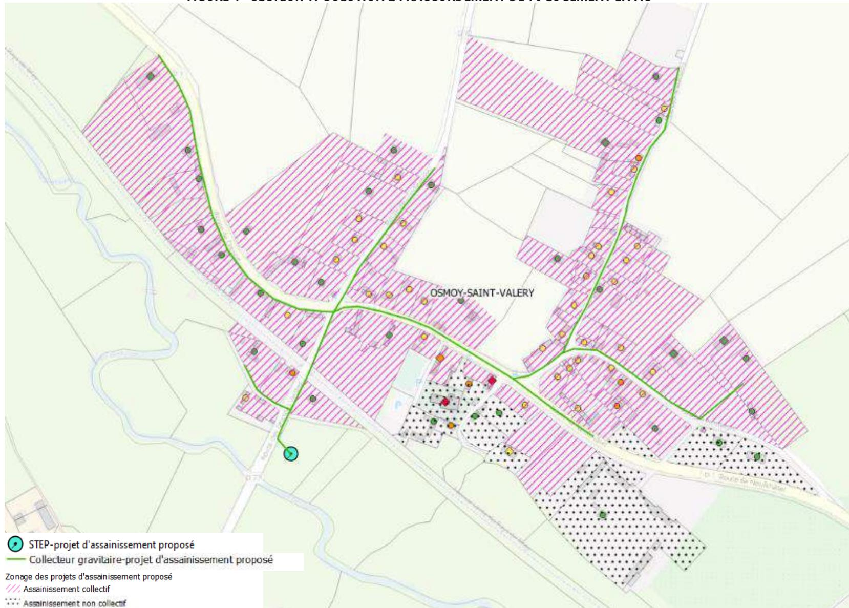
**FIGURE 4 - SECTEUR 17 SOLUTION 2 : LOCALISATION PROPOSEE POUR LA NOUVELLE STATION D'EPURATION**
