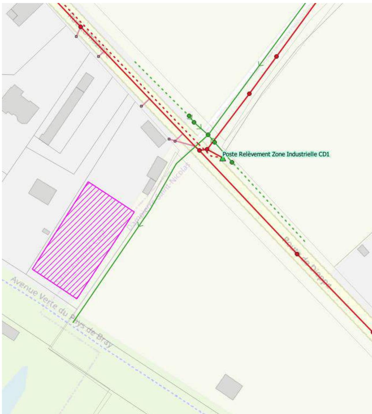
On constate que seul un réseau d'eaux pluviales partant vers un exutoire longe la parcelle sujette à ces débordements. Le trop-plein en amont du PR ZI connecté au réseau d'eaux pluviales pourrait expliquer la présence d'eaux usées lors de ces débordements, mais il a été obturé.
