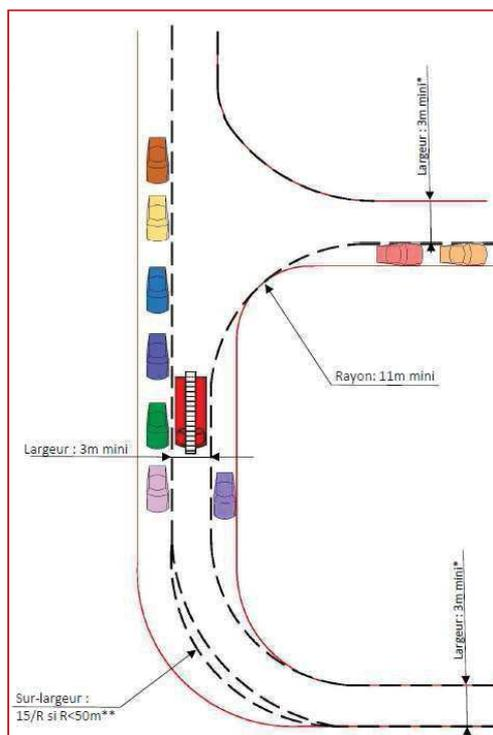
\* la largeur de 3 mètres est portée à 4 mètres si une échelle aérienne doit être déployée à cet endroit. La « voie engins » devient alors une « voie échelle ». La voie échelle est obligatoire au droit des bâtiments dont le plancher bas du dernier niveau est à plus de 8 mètres de hauteur par rapport à la voie carrossable.
