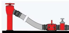
Afin de limiter les perturbations liées à l'écoulement de l'eau, positionner un tuyau de Ø 100 mm d'une longueur minimale de 5 mètres, entre l'hydrant et l'appareil de mesure.
