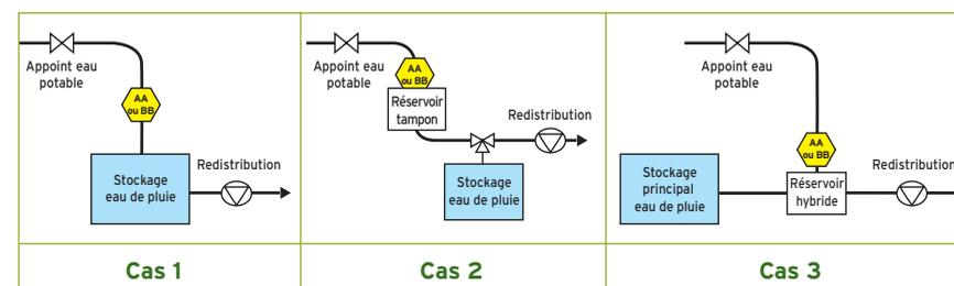
**Remarque** : réaliser une disconnexion AB à l'intérieur du stockage principal ou d'un réservoir hybride est une option **déconseillée** : le dimensionnement de la garde d'air et du trop-plein est alors plus complexe et spécifique à chaque installation.
